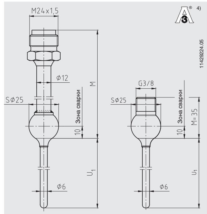
4) Для соответствия стандарту 3-A сварной шов должен выполняться с минимальным радиусом 3,2 мм со стороны процесса. В этом случае гарантируется отсутствие таких дефектов сварки, как трещины и раковины.
