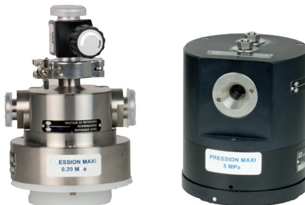
Têtes de mesure de pression absolue et relative
