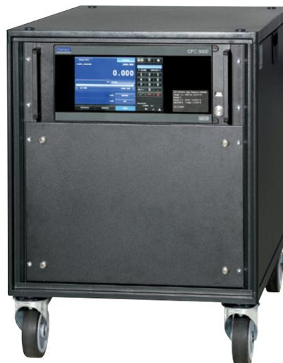
**Controllore di precisione di alta pressione, modello CPC8000-HC**
