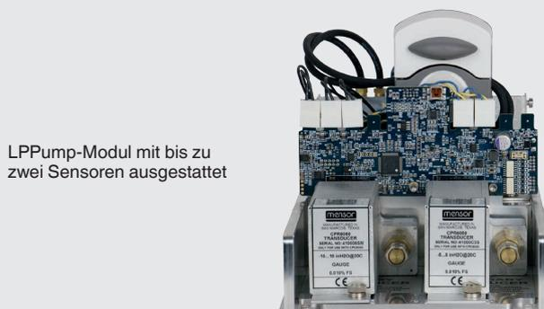
LPPump-Modul mit bis zu zwei Sensoren ausgestattet
