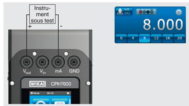
Les signaux de sortie du transmetteur de 0 ... 24 mA peuvent être simulés par une entrée manuelle ou automatique en utilisant les fonctions de rampe et de palier.
