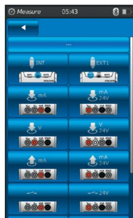
Sélection du type de mesure ou d'étalonnage
